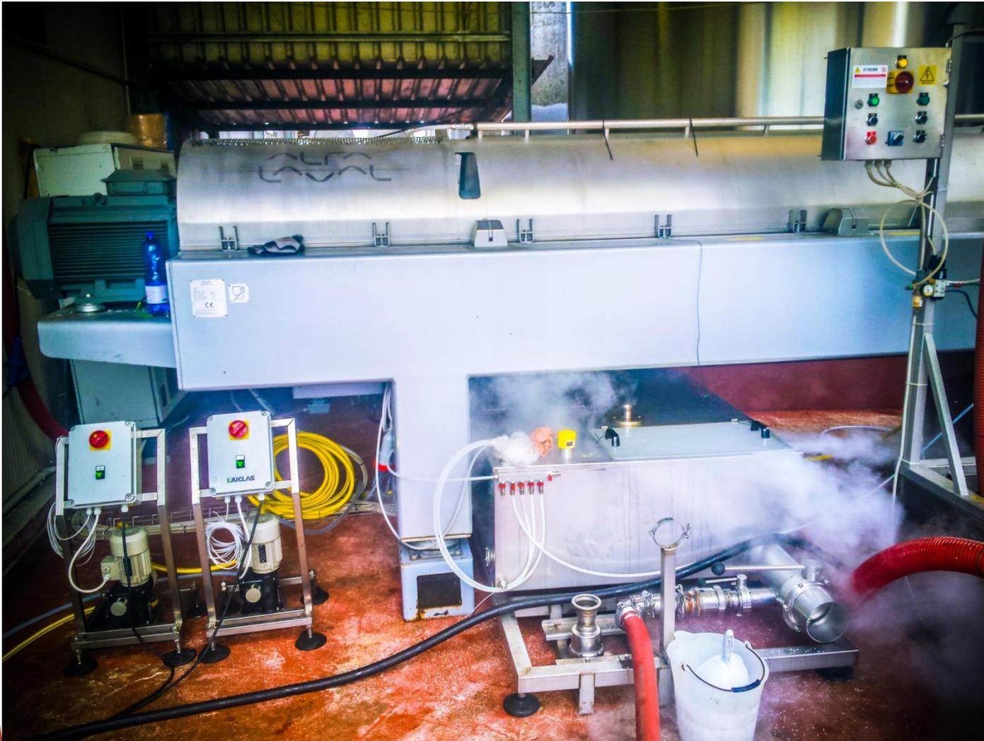
L'uso del Decanter, in combinazione di idonei enzimi e gelatine dosati in linea, permette l'estrazione e l'illimpidimento dei mosti in un solo passaggio.
